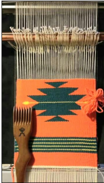
( شكل ٧ ) صورة توضح النول اليدوي - الخيوط الطولية ( السدا ) والخيوط الملونة تسمى خيوط ( اللحمة )
